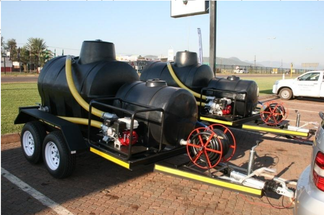
الشكل 7-10/6: منظومة إطفاء حريق متكاملة على مقطورة [11]
